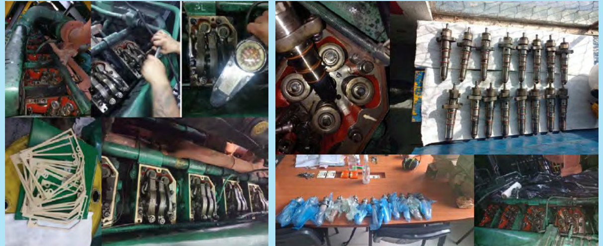
Calibración de válvulas y cambio de empaques.
