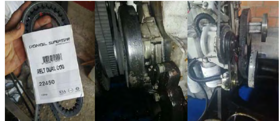
Cambio de la correa del tensor.
