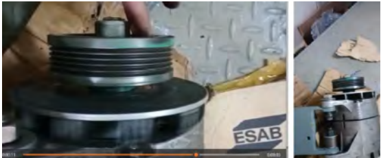
Reparación alternador unidad diésel de Mitú.
